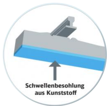
Masse-Feder-System mit elastischer Kunststoffmatte
